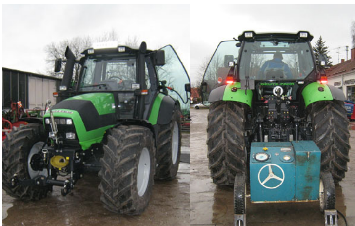
Leistungs-Messgerät rechts an der Zapfwelle
